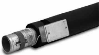
图1 管道表面镶嵌的传感器
