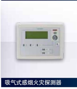
提供火警或故障事件信息显示功能，便于现场人员的及时获得。事件显示与控制器一致，通过查询键可浏览所有显示信息。通过火灾显示盘总线与控制器通讯，每台控制器最多可连接 32 台火灾显示盘。超大背光液晶显示屏，可手动调节对比度。
