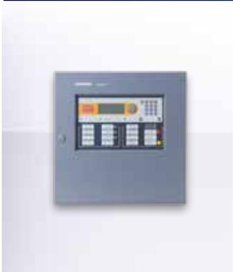
XC18 气体灭火盘适用于西门子所有系列的火灾探测系统，也可与其它品牌的火灾探测系统配套使用。其配备独立运作的气体灭火程序，适用于所有需要气体灭火保护的场所。XC18 配备 LCD 液晶及 LED 指示灯显示，操作一目了然；历史记录内存记忆功能可以确保事件的可追溯性。
