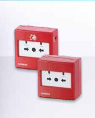
FDM230-CN 手动火灾报警按钮及 FDHM230-CN 消防栓报警按钮均为智能可编址设备，采用可复位式设计，便于操作且无需更换破碎的玻璃，均内置短路器。报警后可通过自带的专用钥匙进行复位。手动火灾报警按钮内置消防专用电话插孔，消防栓报警按钮提供泵运行指示反馈信号显示。
