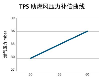
注：风机压力为 60mbar 工况，燃气压力即接口 D 的设定压力，总补偿效果为温度和风压补偿的叠加。
