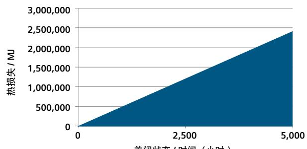
在 ON/OFF 的燃烧系统中蝶阀泄漏导致的热损失
