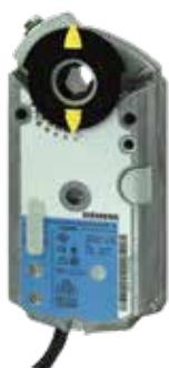
快速角行程风阀执行器 GAP/GNP 191.1.. 支持 2 位、3 位、或连续调节控制。额定扭矩 6Nm，全行程运行时间 2 秒。执行器带有 0.9m 标准连接电缆。
