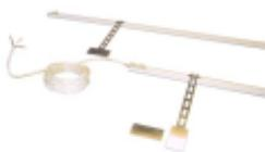
UniTrak 柜门位移传感器的传感元件由导电银带和石墨电阻带叠加组成，两者被夹在聚酯套管中。在传感器的轨道中有一个可移动的滑块，滑块里有一个金属球和弹簧。当滑块移动时，金属球将导电银带和石墨电阻带压在一起，产生与柜门移动距离成正比的电阻输出。UniTrak 传感器是由耐化学腐蚀的材料构成，打开保护盖后可对传感器进行清洗。
