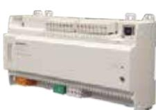
柜门面积计算模块为通风柜控制器提供先进的柜门面积计算管理。它测量通风柜各个柜门的开度位置，合并计算出整个通风柜柜门打开的面积。面积值可以以 0~10V 的模拟输出的方式接入通风柜控制器，也可以通过 SCOM 通信总线将数据传入通风柜控制器。
