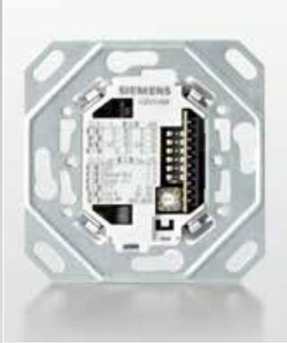
墙面安装传感器系列能够用于所有类型的嵌入式导管分线盒。可提供有源和无源两种类型。有源传感器的输出信号范围可以设置为直流的0...5 V, 0...10 V, 0...20 mA, 4...20 mA以及0/4...20 mA, 并且会为每个测量变量额外配备一个可自由选择的开关触点。因此, Symaro 能够充分满足您的个性化需求。
